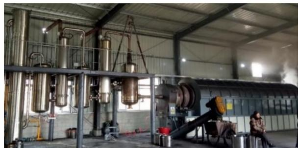
图 5 河北邢台间接加热式回转窑热解中试装置
