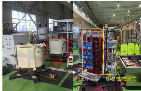
(a) 试验现场图(左为 LC 回路，右为断路器样机)
