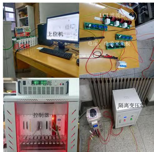
图 15 实验样机示意图
