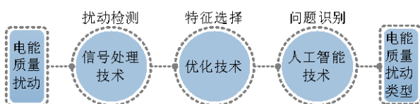
图 1 电能质量扰动检测与识别技术框架
