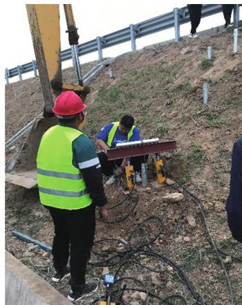
图4 静载试验的现场照片
