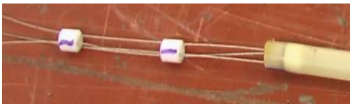
(a) 钢丝绳穿过定位盘和套管
