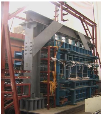
图 1 安装完成后的模型试验钢结构架 Fig.1 The structural steel frame for model tests
