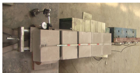
图4 多点位移计标定试验装置
