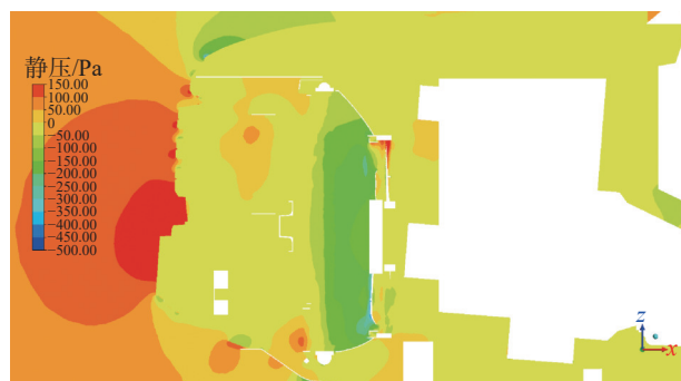
图3 车身横向中间位置典型静压分布云图
