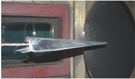
图 4 风洞试验模型 [25] Fig. 4 Wind tunnel test model [25]
