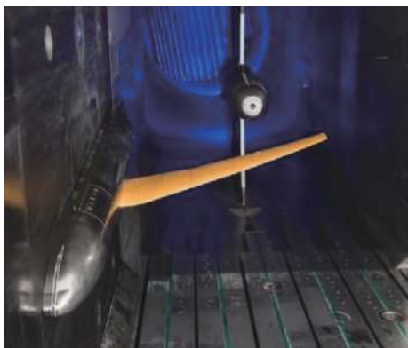
图 2 CRM-NLF 风洞试验模型 [34] Fig. 2 Test model of CRM-NLF [34]
