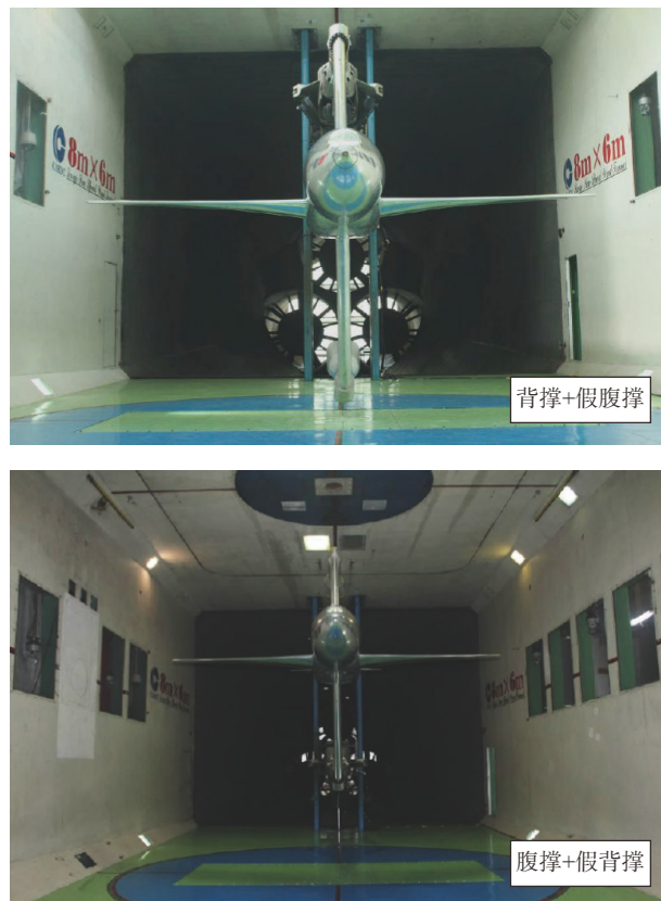
图5 CHN-T1 标模支撑干扰试验
