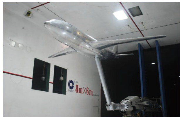
图 1 8 m × 6 m 低速风洞悬臂支撑机构
