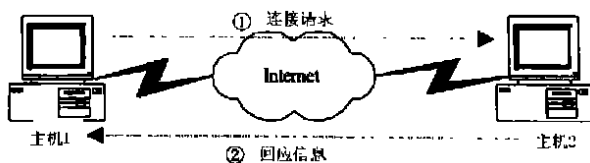
图 1 静态 IP 地址系统的寻呼示意
