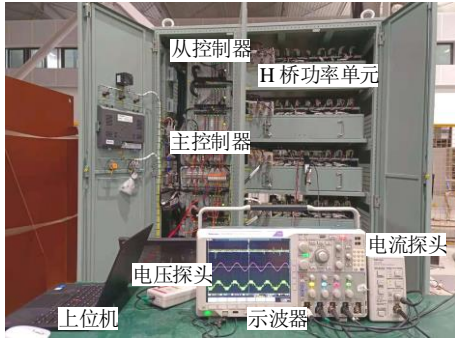
图 17 三相 4L-NNPC H 桥变频器及其控制系统
