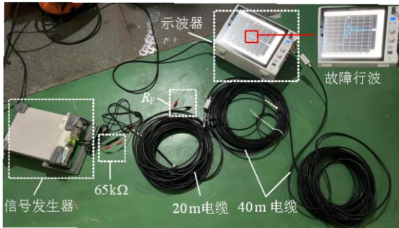
图 15 RG-58 电缆试验接线示意图
