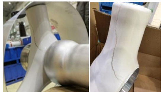
图 18 真丝布混擦三支柱绝缘子引起的放电痕迹
