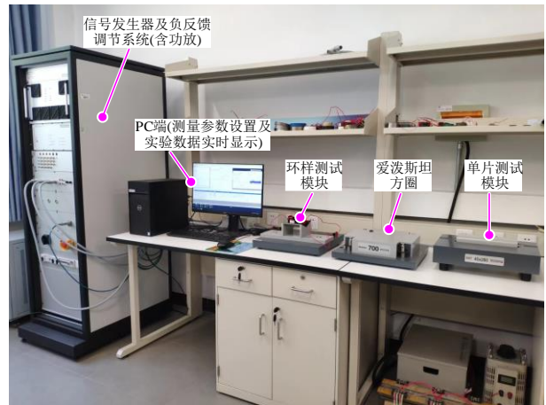
图6 Brockhaus-MPG200 磁特性测量系统
