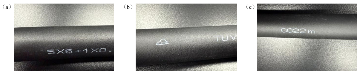
图 6 不同挤出模具挤出的护套表面示意图:(a)挤压模具;(b)半挤压模具;(c)挤管模具
