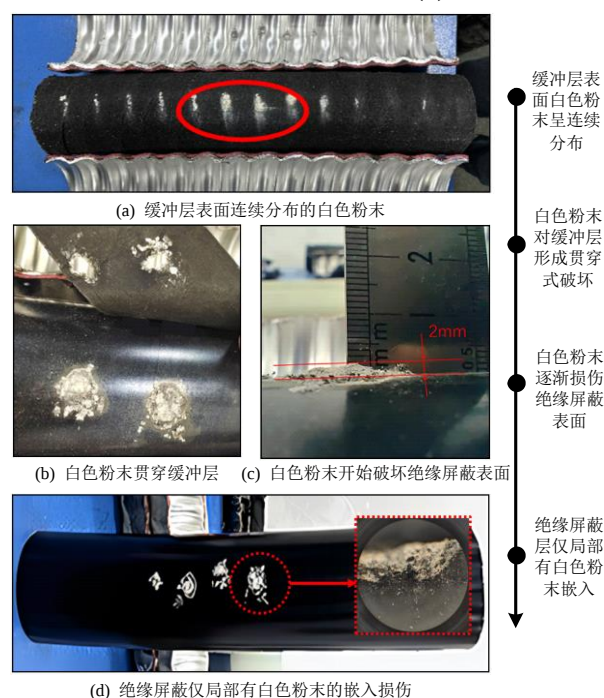
图 1 含白色粉末的电缆缓冲层烧蚀缺陷特征
