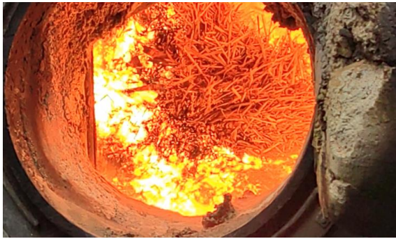
图 2 底部着火层燃方式的实炉照片 Fig. 2 On-site photo of bottom-ignited layer combustion
