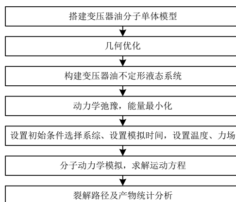
图 12 变压器油的分子动力学模拟流程
