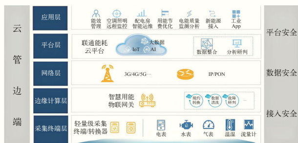
图4 一种常见的智慧能源管理平台 (IEMP) 结构示意图
