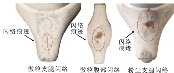
图 14 附着金属异物的三支柱绝缘子闪络痕迹
