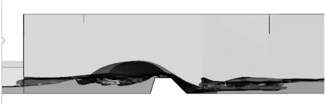
图 11 放空洞出口水流流态示意
