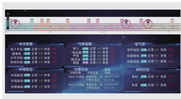
图5 智慧管廊监测界面
