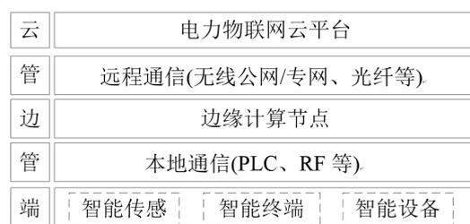
图 1 电力物联网架构
