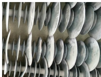
图1 伞裙的老化现象
