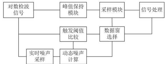
图 4 局放信号采样示意图
