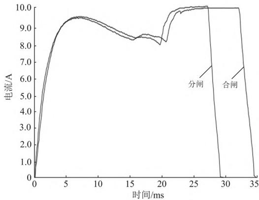
图 6 分(合)闸线圈电流高速录波曲线
