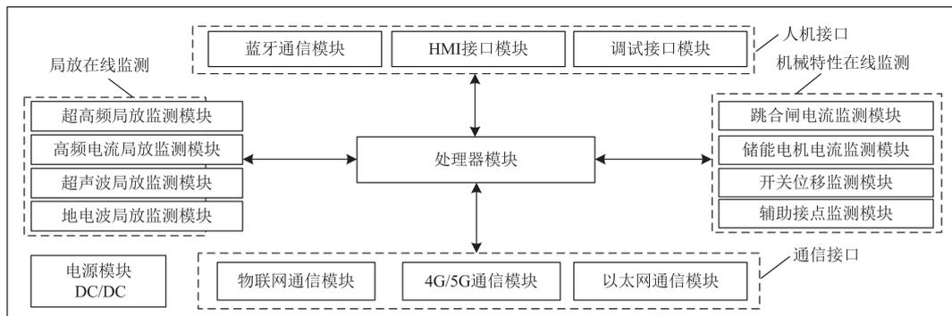
图 1 装置功能模块架构
