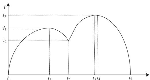
图 3 典型分(合)闸线圈电流曲线
