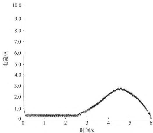
图 7 储能电机电流高速录波曲线
