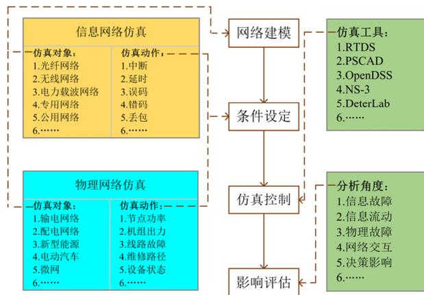
图7 电力信息物理耦合仿真架构
