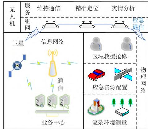
图 10 引入无人机通信后应急网络结构
