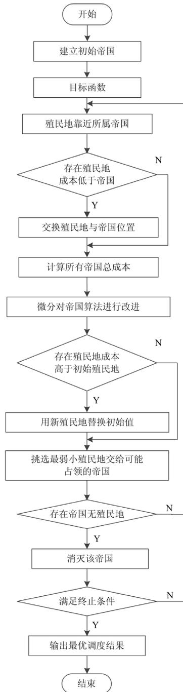
图3 改进算法流程图
