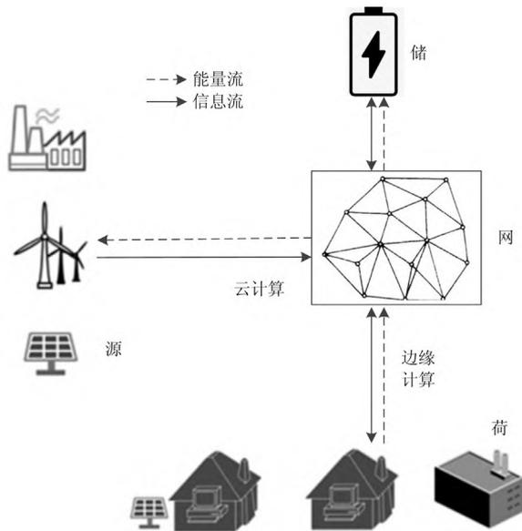
图1 调度系统架构
