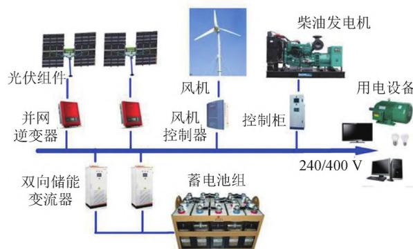
图1 微电网系统结构
