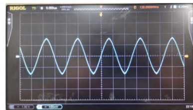
(b) 等效负载为可变电阻时发射端输出电流波形
