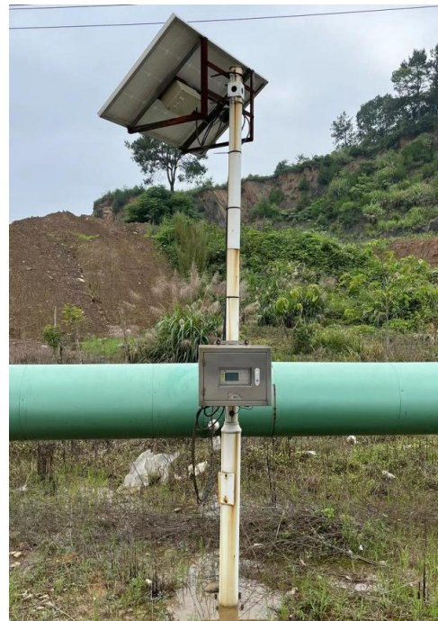
图 1 现场的温度实时检测装置
