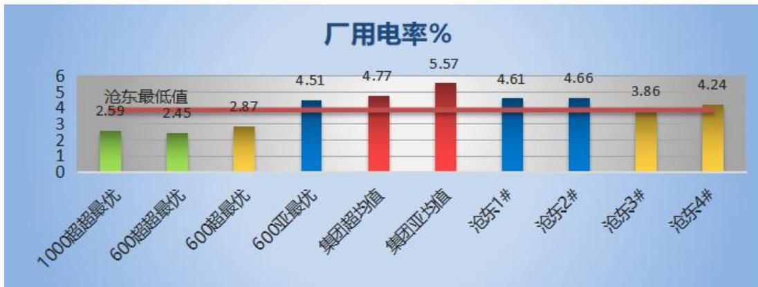
图 2 沧东电厂 4 台机组厂用电率与行业优胜机组对比
