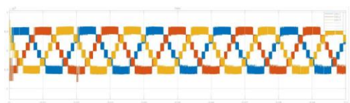
图 10. 堆栈电压波形 Q_{reference}=0.25 I_{in}=100A
