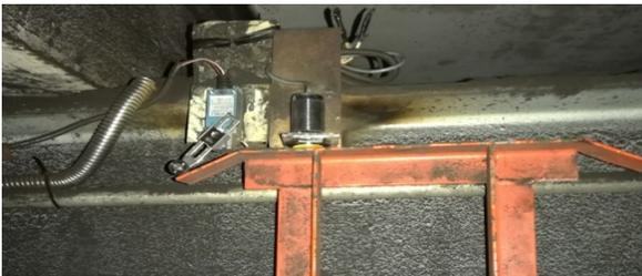
图3 行走小车定位限位安装图
