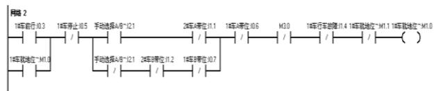
图5 除铁器 PLC 修改后程序图
