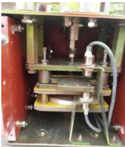
图 7 电磁斥力真空开关原理及结构图
