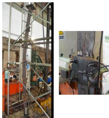
图 4.9 T 形组合角钢构件 LDM1 破坏形式
