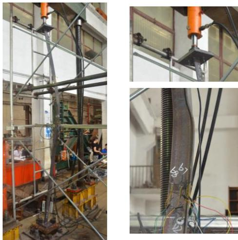
图 4.4 单角钢 LDO3 构件破坏形式
