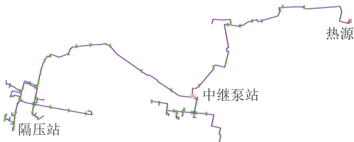
图7 基于viHeating的长输供热管网模型
